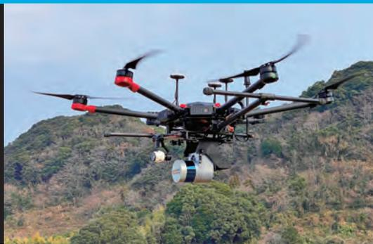
現在、公共関連のレーザ測量が多く、続いて建設関連の ICT 測量が多くなってきています。昨年からの水害で熊本県球磨川全般のレーザ測量・福岡県朝倉で水害でのレーザ測量及び写真測量が多く、次いで長崎での世界遺産でのレーザ測量を行っております。点検では、雲仙砂防施設点検でのレーザ測量及び空撮を受けております。また、長崎高速道路のレーザ測量から ICT 設計までを行っておりますので自信をもってお受けできます。
