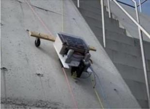
法面移動機体<br>
